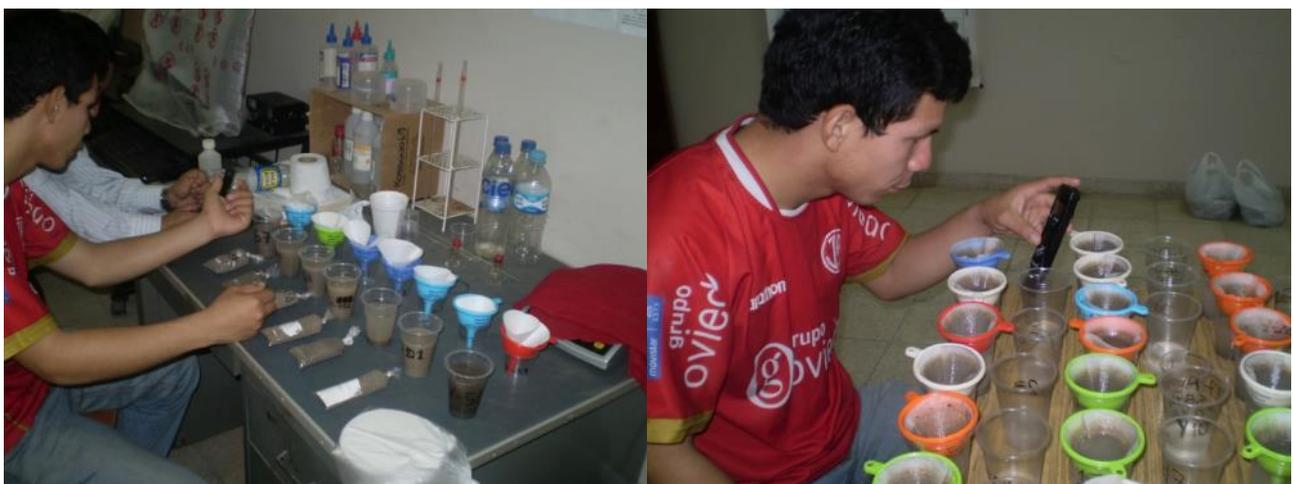
**Figura 5.2:** (Izquierda) Preparación de los extractos 1:5 y (derecha) medición de la CE y pH empleando un sensor digital. La preparación y medición de las muestras se llevó a cabo en el Laboratorio de Suelos de la Facultad de Agronomía de la Universidad Nacional Pedro Ruíz Gallo de Lambayeque.
